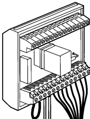
Permet la synthèse de défauts d'origines diverses (8 maxi par module) et leur report sur un relais instantané à 4 contacts inverseurs. Les contacts secs sont isolés galvaniquement et permettent, par relais, le report des signaux de défauts (entrée 230 V ou 110 V) sur des systèmes de sécurité sonores, visuels, gestion technique centralisée...
