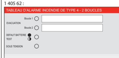
Voyant rouge «EVACUATION» «Boucle 1» / «Boucle 2» : allumé en fixe pour signaler un feu sur la boucle concernée (suite à l'appui sur un DM). Clignote après le cycle d'alarme jusqu'au réarmement de l'ensemble des DM actionnés.
