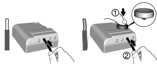
A l'aide de l'outil fourni ou d'un tournevis de 2,5 mm, appuyez sur le bouton de la borne puis insérez le fil.
