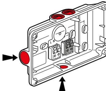
A la livraison 2 trous pour le passage de câbles sont percés, ils sont à équiper (en fonction de l'arrivée du câble) l'un avec le presse-étoupe l'autre avec le bouchon.
