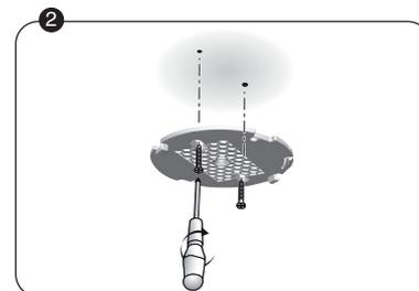
2 Tracez et percez les trous à l'emplacement prévu. Fixez le socle avec la visserie adaptée au support.
