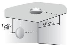
• Le détecteur doit être fixé, de préférence, au plafond et au centre de la pièce. Sinon, fixez le à plus de 20 cm de tout obstacle (mur cloison, poutre, ...) et à plus de 60 cm de tout angle de la pièce.
