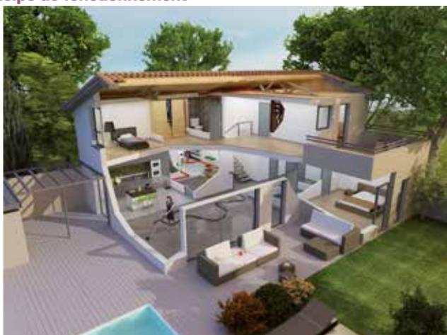
Principe de fonctionnement de l'aspiration centralisée
