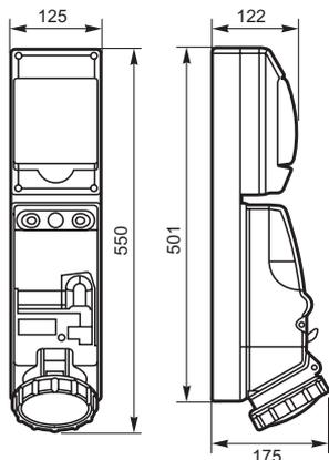
Coffret monoprise 63A avec interrupteur version encastrée
