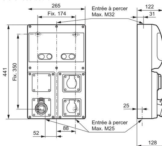
4. prises avec disjoncteur et interrupteur différentiel
