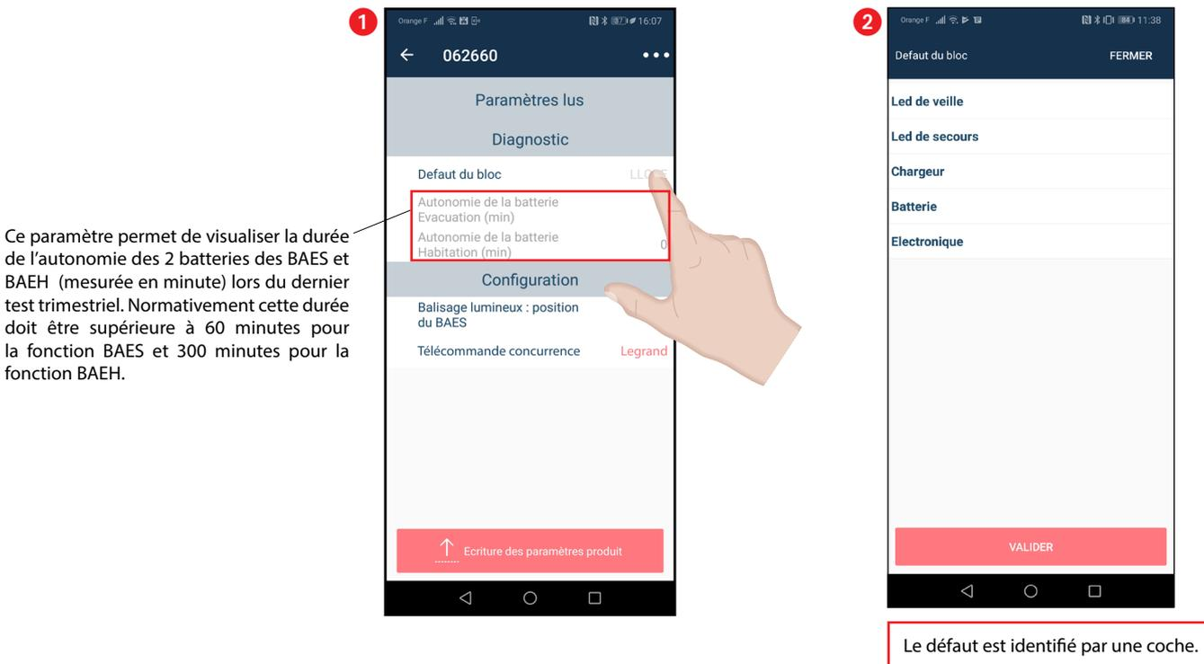
Ce paramètre permet de visualiser la durée de l'autonomie des 2 batteries des BAES et BAEH (mesurée en minute) lors du dernier test trimestriel. Normativement cette durée doit être supérieure à 60 minutes pour la fonction BAES et 300 minutes pour la fonction BAEH.
