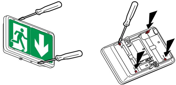
Les accumulateurs doivent être remplacés lorsque le bloc autonome ne satisfait plus à sa durée assignée de fonctionnement.
