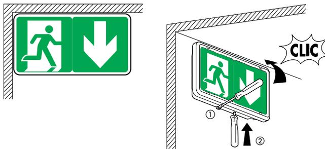
⚠ Déverrouillage possible avec un tournevis en l'enfonçant jusqu'au fond du bloc (longueur de la lame minimum 110 mm).
