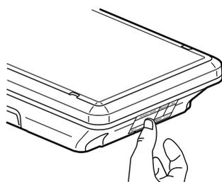
Cette étiquette de maintenance réf. 0 609 00) doit être apposée de manière visible sur chaque bloc autonome d'éclairage de sécurité en y inscrivant la date de mise en service du bloc.
