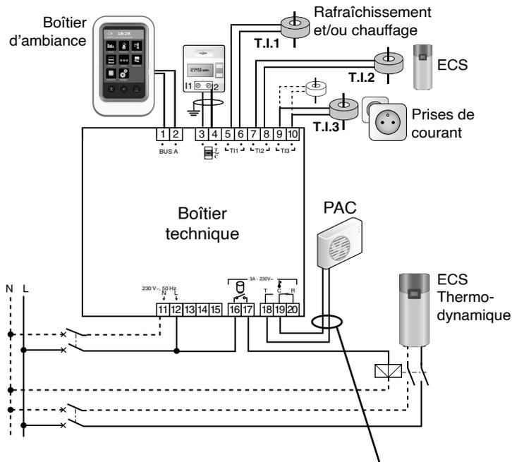
La sortie régulation peut aussi être déportée via un récepteur radio de type Marche/arrêt (ex : TYXIA 4600). Voir menu Réglages / Réglages avancés / Réglages thermiques / Réglages installation / Associations.
