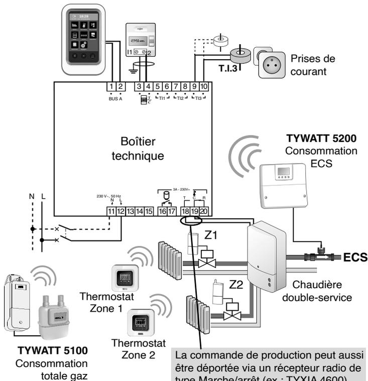
La commande de production peut aussi être déportée via un récepteur radio de type Marche/arrêt (ex : TYXIA 4600). Voir menu Réglages / Réglages avancés / Réglages thermiques / Réglages installation / Associations.
