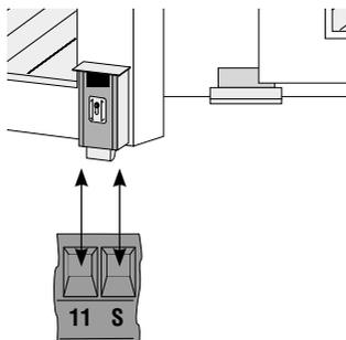
Connexion serrure de verrouillage
