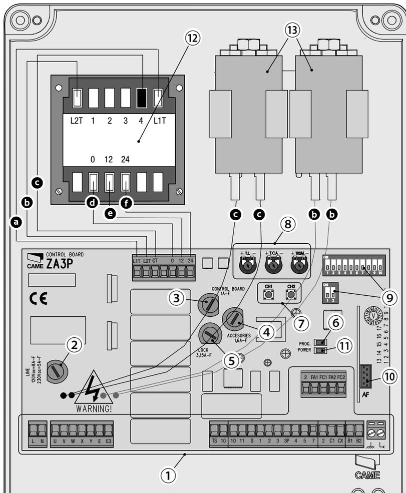
\*<sup>(13)</sup> Inclus dans l'emballage des motoréducteurs FROG 230 V. Les connecter aux câbles noirs (moteur M1) et rouges (moteur M2), prévus dans la carte ; en présence des motoréducteurs Ati, Fast, Ferni et Krono, ces câbles ne sont pas utilisés (les condensateurs sont connectés à l'intérieur).
