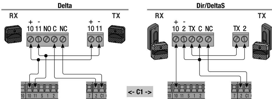
Connexion pour **la réouverture durant la fermeture** (contact NF). - Avec dispositifs de sécurité type photocellules, bords sensibles et autres dispositifs conformes à la norme EN 12978. Durant la phase de fermeture, le contact provoque l'inversion du mouvement jusqu'à l'ouverture totale.
