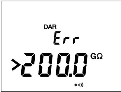
Pour le C.A 6524 ou le C.A 6526, si cela survient pendant une mesure de DAR ou de PI, l'appareil interrompt la mesure et affiche l'écran ci-contre.
